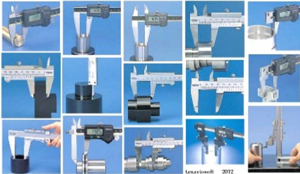
Fig. 5. Tehnici de măsurare cu șublerul
