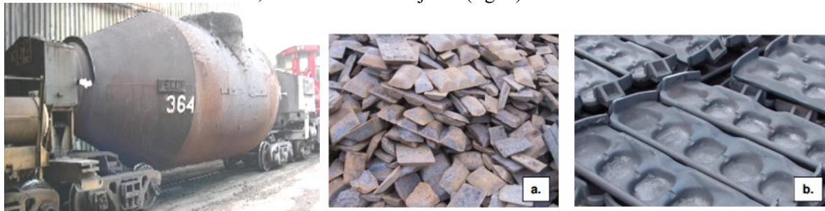
Fig.3. Transportul fontei în melanjoare spre oțelărie Fig.4. a) Calupuri de fontă; b) Forme pt. fontă
